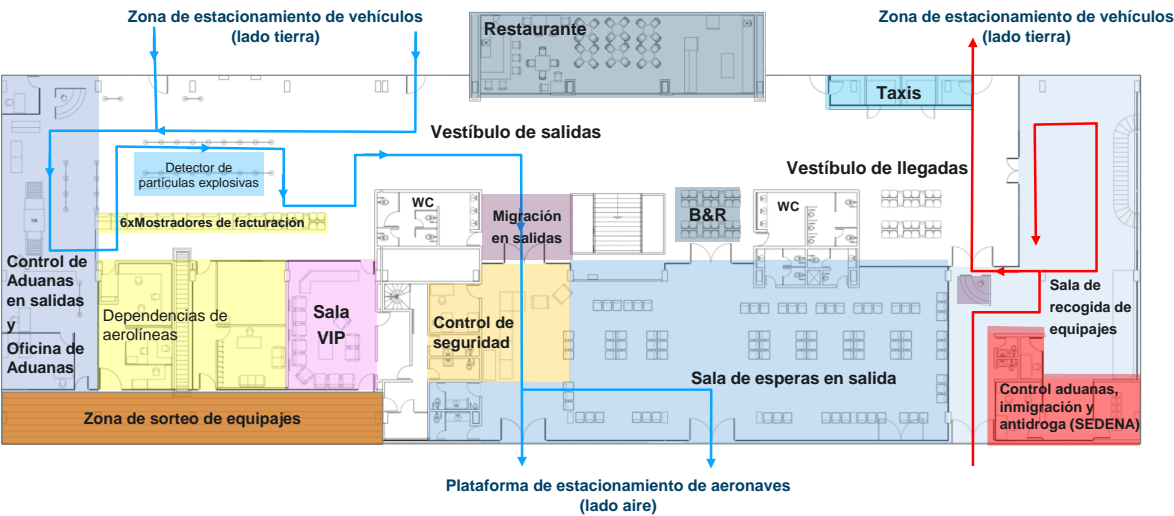
Planta y distribución interior del edificio terminal, nivel 1
